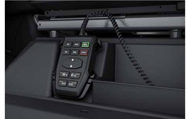
Bedieneinheit für elektronisch geregelte Luftfederung (VASC)
