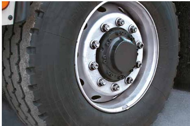
Vorderachse mit hydrostatischen Radnabenmotoren
