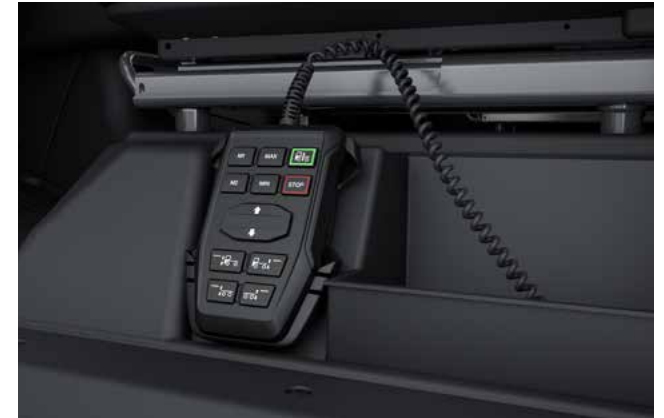
Bedieneinheit für elektronisch geregelte Luftfederung (VASC)
