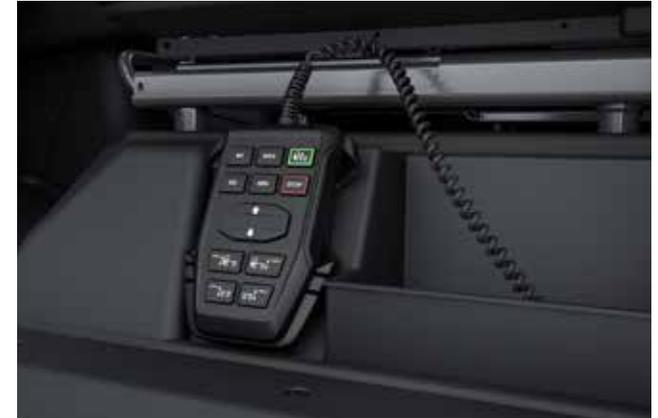
Bedieneinheit für elektronisch geregelte Luftfederung (VASC)
