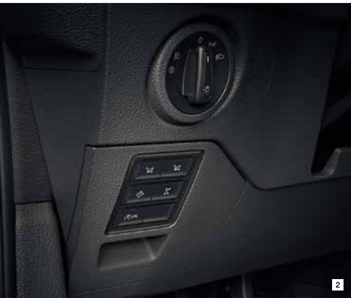
1 – Kastenwagen Plus (verfügbar in verschiedenen Fahrzeuglängen und -höhen); 2 – Separates Bedienfeld für die Aufbauteuerung, vom Fahrersitz oder von aussen bedienbar; 3 – Abschleppfahrzeug
