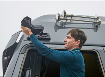
Die Haltearme sind in zwei Richtungen klappbar
